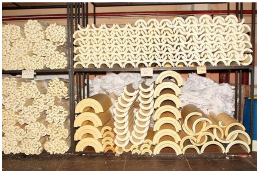
Рисунок 3. Изготовление скорлуп для теплоизоляции труб. Промежуточное хранение на стеллажах на площадке
