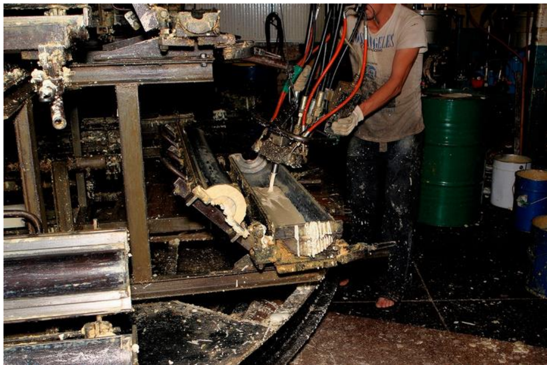
Рисунок 4. Изготовление скорлуп для теплоизоляции труб. Заливка ППУ системы в форму на карусельной платформе
