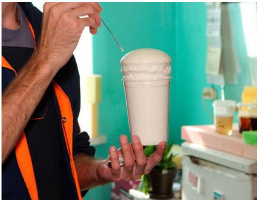
Рисунок 2. Проведение теста технической пробы. Определение времени гелеобразования
