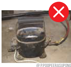
РИС. 8: ДЛЯ ВАКУУМИРОВАНИЯ КОМПРЕССОРЫ ИСПОЛЬЗОВАТЬ НЕЛЬЗЯ
