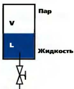
Положение баллона для откачки жидкости
