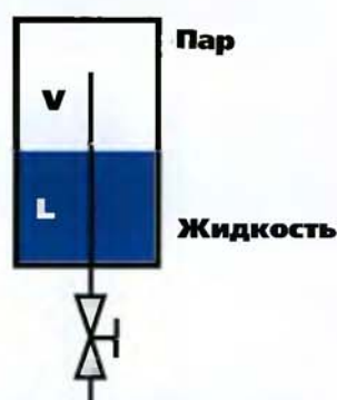
Положение баллона для откачки пара
