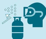
ПРИ ОТКРЫВАНИИ ВЕНТИЛЯ ЦИЛИНДРА ВЫХОДНОЕ ОТВЕРСТИЕ ЦИЛИНДРА ДОЛЖНО БЫТЬ НАПРАВЛЕНО В СТОРОНУ РАБОТАЮЩИХ
