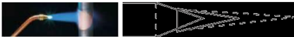
Рис. 1. Оптимальный вид пламени горелки для пайки твердым припоем: 1 -факел пламени, насыщенный газом; 2 -факел ярко синего цвета
