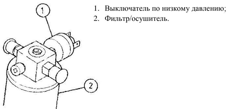
Рис.15. Типичный выключатель по низкому давлению для установки в системах с расширительным клапаном и фильтром/осушителем.
