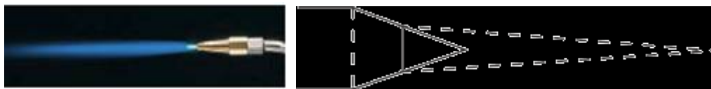
Рис. 2. Факел пламени горелки при сбалансированной газовой смеси (ярко синего цвета и небольшой величины)
