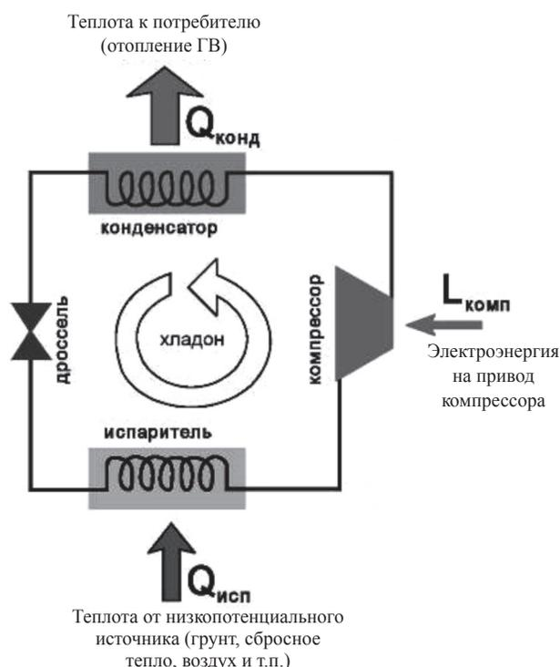
Рисунок А.1 – Принципиальная схема парокомпрессионного контура ТН
