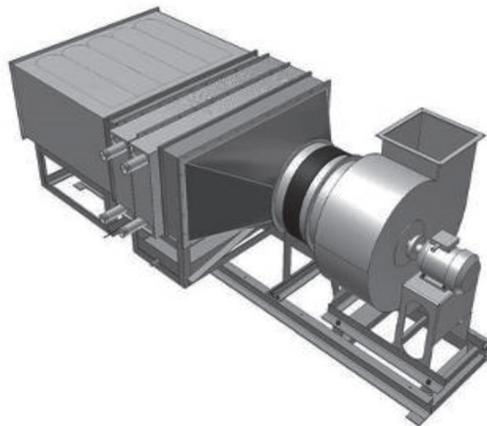
Рисунок 3 – Общий вид агрегата утилизации теплоты
