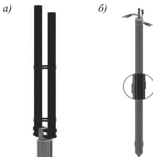
а) – U-образный грунтовой теплообменник из полимерных труб;
