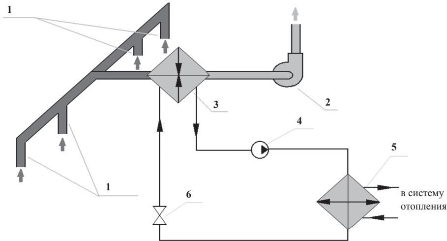
1 – вытяжные шахты; 2 – вытяжной вентилятор;
