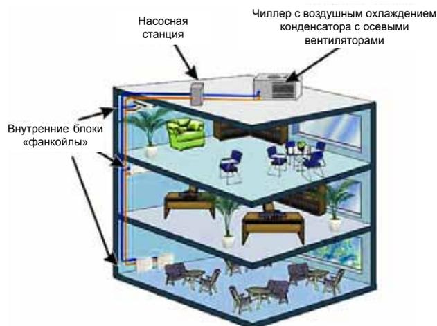
Рис.1 Принципиальная схема системы «чиллер-фанкойл»
