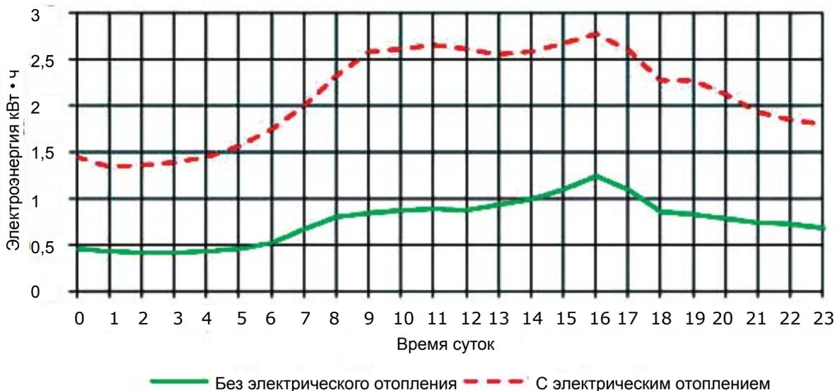
Электрическая кривая нагрузки жилого дома с и без электрического отопления.
