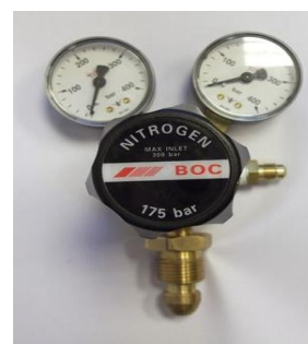
Рисунок 5.10. Надлежащий редуктор для опрессовки систем на R744
