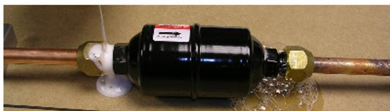
Пример: появления пузырьков при утечке
