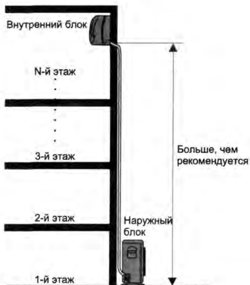
Рис. П6.2. Превышение допустимой разницы высот между наружным и внутренними блоками сплит-системы
