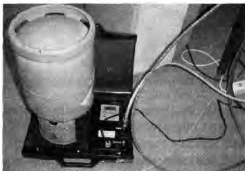
Рис. 5.28. Баллон с хладагентом на электронных весах
