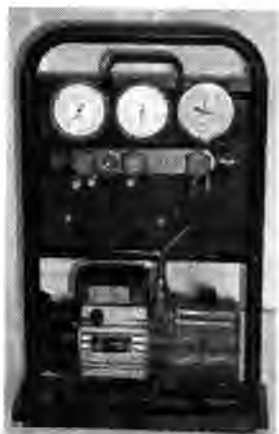
Рис. 5.24. Вакуумный насос с манометрическим коллектором
