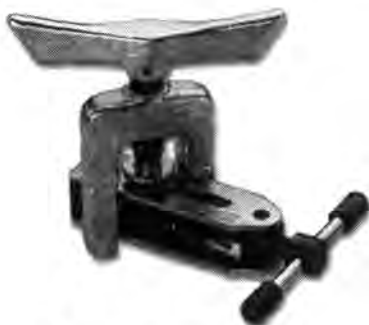
Рис. 4.17. Внешний вид развальцевателя
