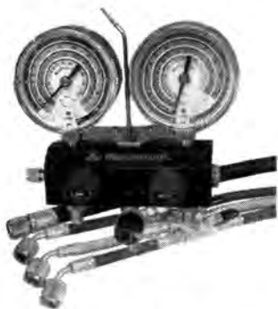
Рис. 4.5. Внешний вид манометрической станции
