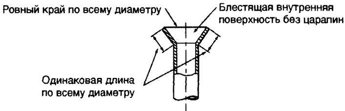
Рис. П2.23. Проверка развальцовки
