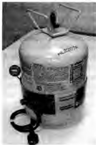
Рис. 5.30. Заправочный баллон с электронагревателем
