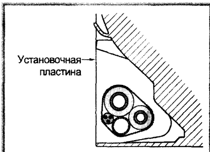
Рис. ПЗ.22. Размещение пучка из трубок, кабеля и дренажного шланга в нижней части комнатного блока
