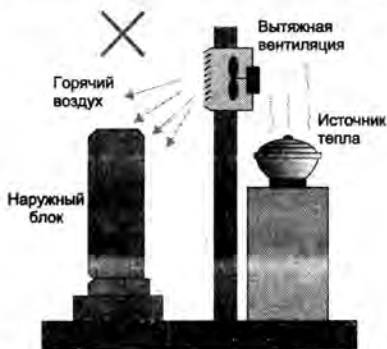
Рис. П6.8. Недопустимое расположение наружного блока рядом с выходом вытяжной вентиляции
